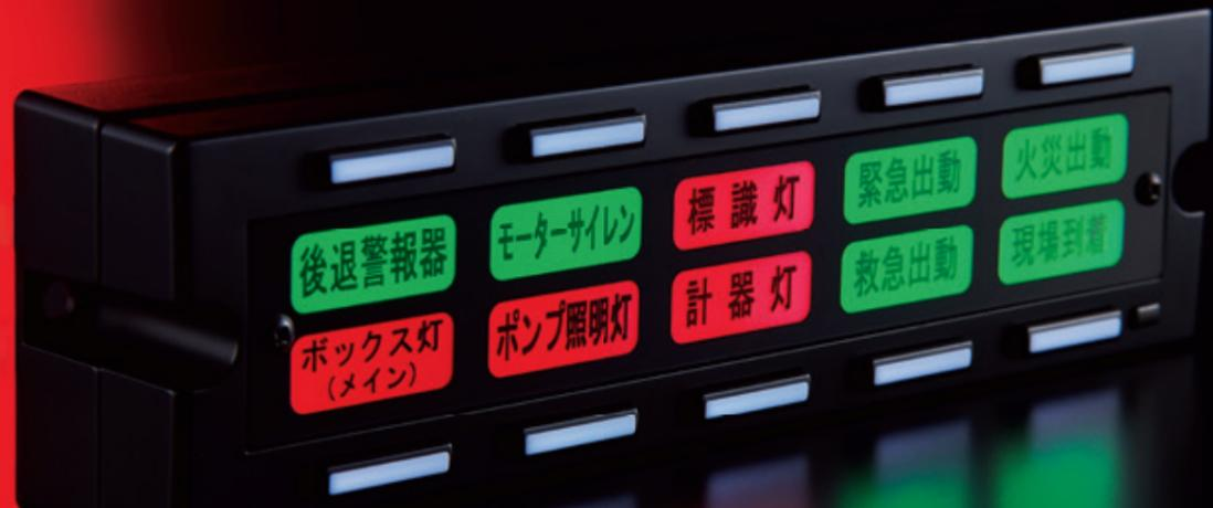
SBW-D1は10個のスイッチにより、車両に装備する様々な電装機器を操作する集中スイッチです。「操作部」とこれに接続する「リレーボックス」で構成され、「操作部」のスイッチで操作します。
